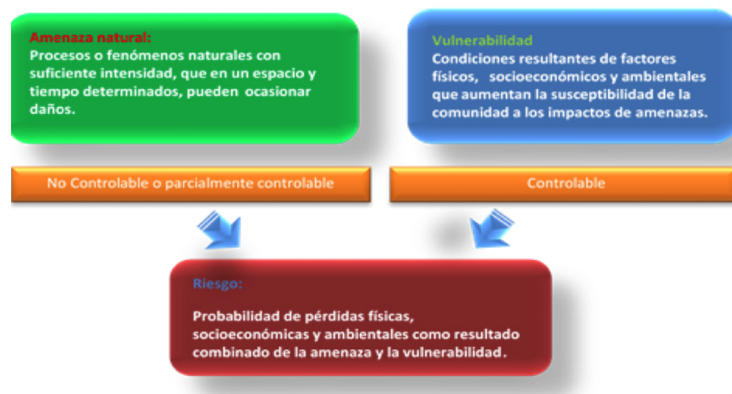
Figura 5. Esquema de análisis del riesgo como una función de amenazas y la vulnerabilidad.
