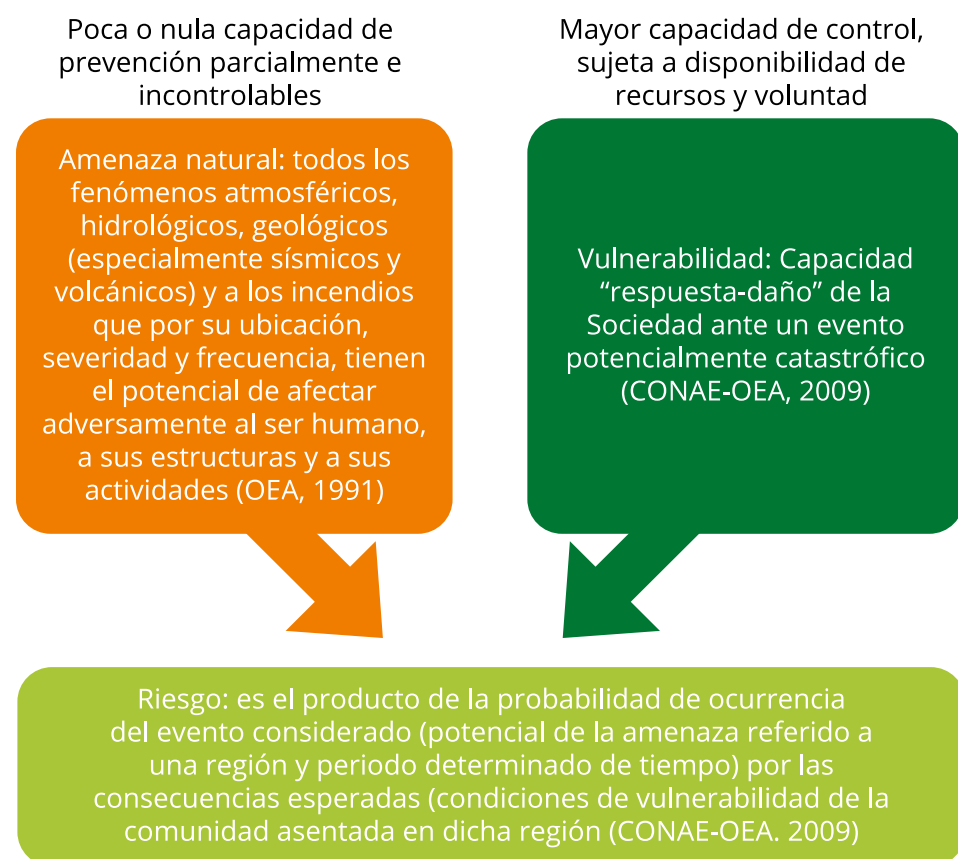
Figura 5. Esquema del riesgo en función de las amenazas y de la vulnerabilidad.
